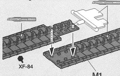
●接着剤が他の部分につかないように履帯の端を図のようにはめ込み、接着します。このとき、接合部がはがれやすいのでしっかりと接着してください。
