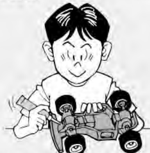
⑧ ギヤや軸受け部、サスペンションなどの可動部はグリスをさしておきましょう。
