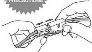
走行させない時は必ずバッテリーのコネクターを外してください。走行用バッテリーをつないだままでおくと、車が暴走することがあります。走らせないときは、必ず走行用バッテリーのコネクターを抜いておきます。
