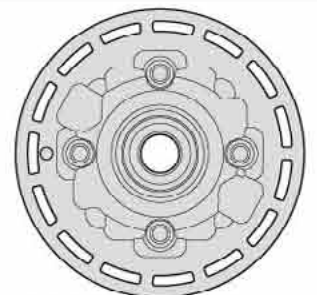
ギヤデフプーリーケース...X2 Differential case 51566 Differentialgehäuse Carter de différentiel
