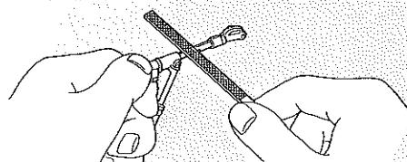
②次に1000番程度の紙やすりで表面をみがき、スーパーサーフェイサーを吹きつけてから塗装します。※必ずスーパーサーフェイサーをふきつけてください。吹きつけないと塗装がはがれおちてしまうので注意して下さい。
