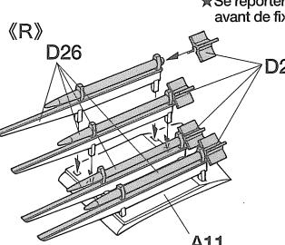
★タイプAとタイプBの機体ではA11とA12の塗装とマーキングが違います。P9とP10を参考にD26を取り付ける前に塗装とマーキングを行って下さい。
