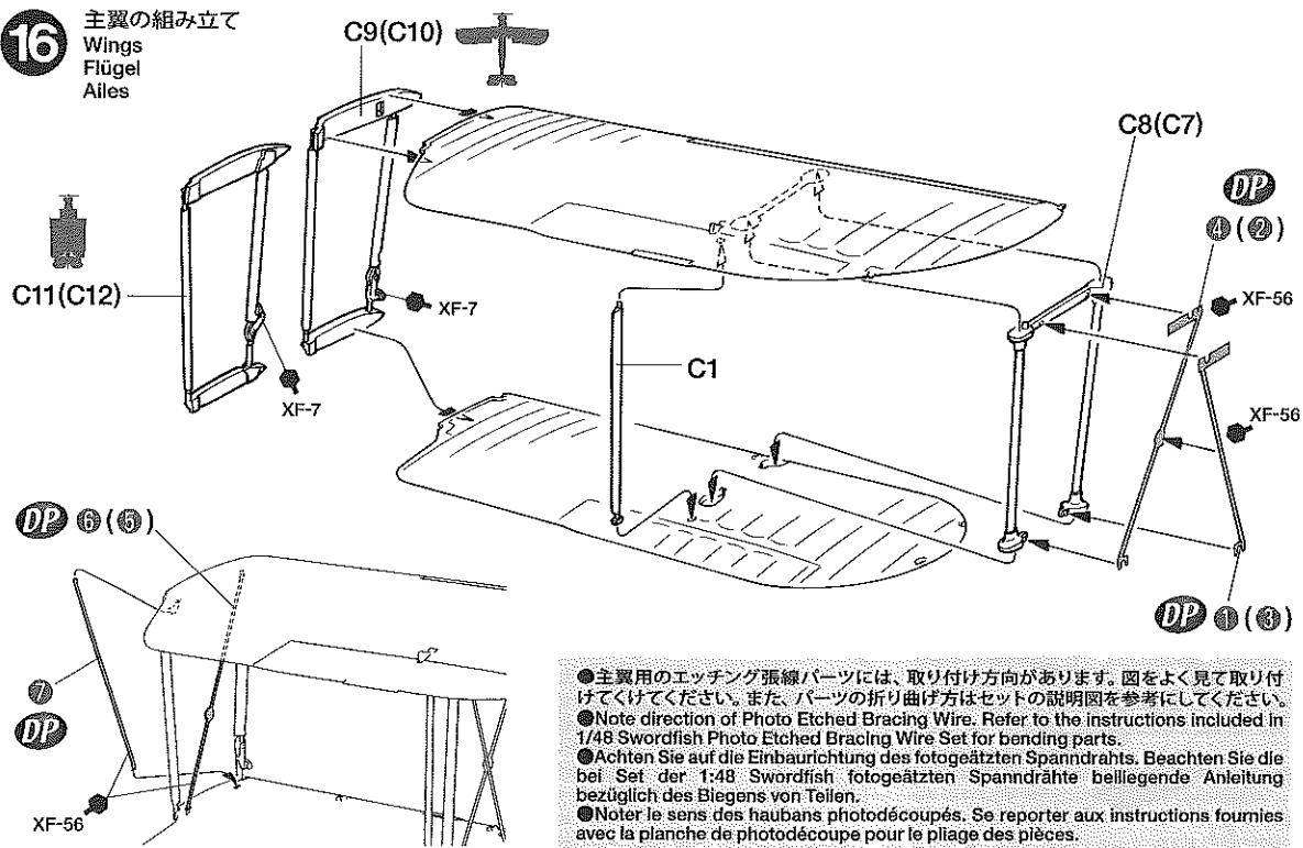
●主翼用のエッチング張線パーツには、取り付け方向があります。図をよく見て取り付けてください。また、バーツの折り曲げ方はセットの説明図を参考にしてください。
