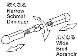
★ターナックルシャフトを回転させて長さを調整します。
